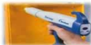
Aplicación de pintura en polvo
