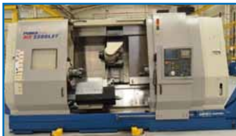
Torno cnc de 9 ejes DOOSAN PUMA MX 2500 LST. cnc FANUC . E.P. 1520 mm. Ø max. mecanizable 540 mm.
