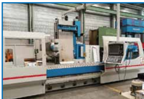
Fresadora SORALUCE TR-35 cnc HEIDENHAIN TNC-426 Recorridos: 3500x1200x1600 mm. Cargador 30 herramientas. Cabezal automático.
