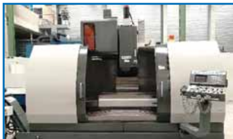
Centro de mecanizado DHALIH MCV 1450 cnc FANUC Recorridos 1450x750x750 mm. Cono ISO-50 . 6000 RPM.
