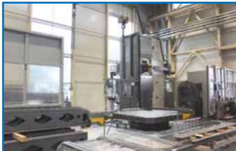
Fresadora ZAYER 30KCU 16000 AR cnc HEIDENHAIN iTNC 530 (3+2 ejes) Recorridos 16000x1500x3500mm. Cargador 100 herramientas
