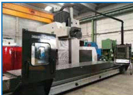
Fresadora ZAYER 30KF-5000 cnc HEIDENHAIN TNC-426 . Recorridos: 4710x1508x2013mm. Cabezal automático
