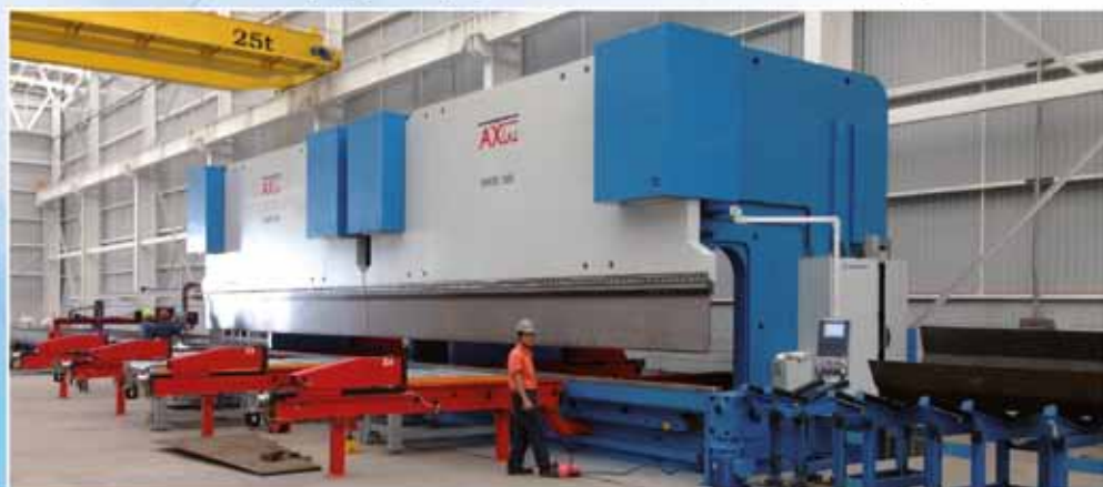
Línea automática de plegado: 2 plegadoras en tándem, 3000 toneladas y 16 metros.
