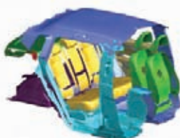
Diversos digitalizados de interiores de Automoción con Handyscan.
