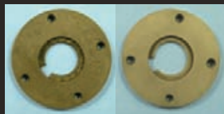
La misma pieza tras granallado incluyendo MCBM
