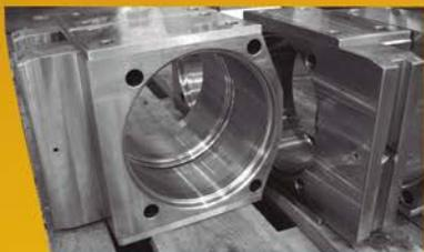
Gracias al bajo contenido de carbón, Toolox se mecaniza muy bien y además es apto para soldadura y corte en caliente.
