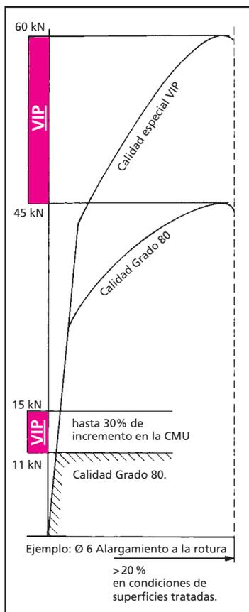
Las cadenas y componentes VIP están provistas de una **doble protección exterior**, consistente en dos procesos: pretratamiento y recubrimiento rosa. Como resultado se obtiene una inmejorable protección comparándola con un acabado galvanizado.
