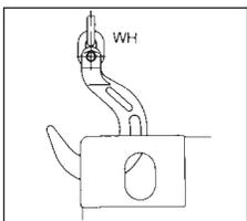
Los contenedores 1D, 1E y 1f (<9 ft) pueden ser levantados desde sus esquinas suerios con una eslinga de 4-ramales, siempre y cuando el ángulo de inclinación de los ramales no supere los 30°.
