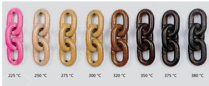
El recubrimiento especial VIP rosa-fluorescente indica permanentemente la temperatura a la que se ha sometido la eslinga de cadena.
