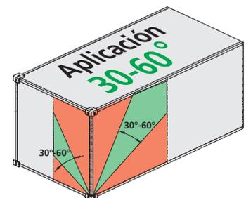
VCH – 10 t para contenedores con esquinas según ISO. Conexión fija mediante VVS o VVGSCH. Se puede utilizar como componente individual para conexiones con gancho.
