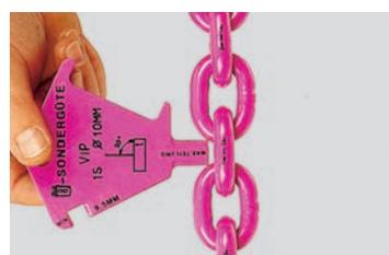
Comprobación del alargamiento plástico del eslabón por sobrecarga.
