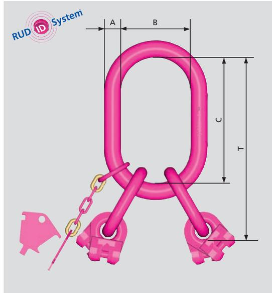
VAK 4-Anilla Maestra está provista del conector de cadena VRG. Por ello sólo puede ser conectado el diámetro de cadena y el nº de ramales correctos. También incorpora la placa de identificación. VIP-Bulón y pasador elástico pre-montado. Dimensiones correspondientes al eslabón principal VAK 4, según DIN 5688.
