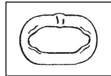
■ **Accesorios:** Los ganchos serán retirados cuando la apertura de la boca se deforme en más de un 10 %, y también si el gancho está erosionado en más de un 5 %, o si presenta grietas.
