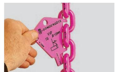
Comprobación del alargamiento del paso del eslabón por desgaste del diámetro nominal.
