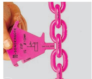
Comprobación del paso del eslabón provocado por el desgaste del diámetro nominal
