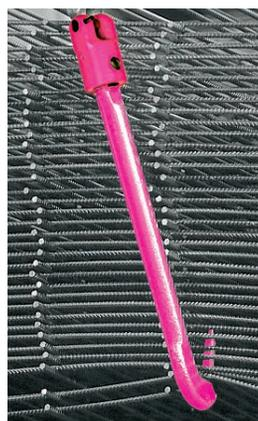
Gracias a la espalda aplanada del gancho, se facilita el enganche en los paquetes de malla. Con conexión directa la cadena a través del cabezal conector que integra un giratorio con rodamientos de bolas-la cadena se destuerce automáticamente.
