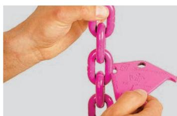
Comprobación del desgaste del diámetro nominal del eslabón.
