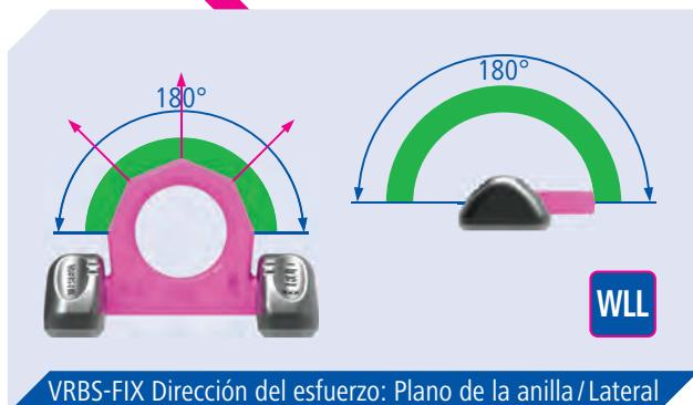
VRBS-FIX Dirección del esfuerzo: Plano de la anilla / Lateral
