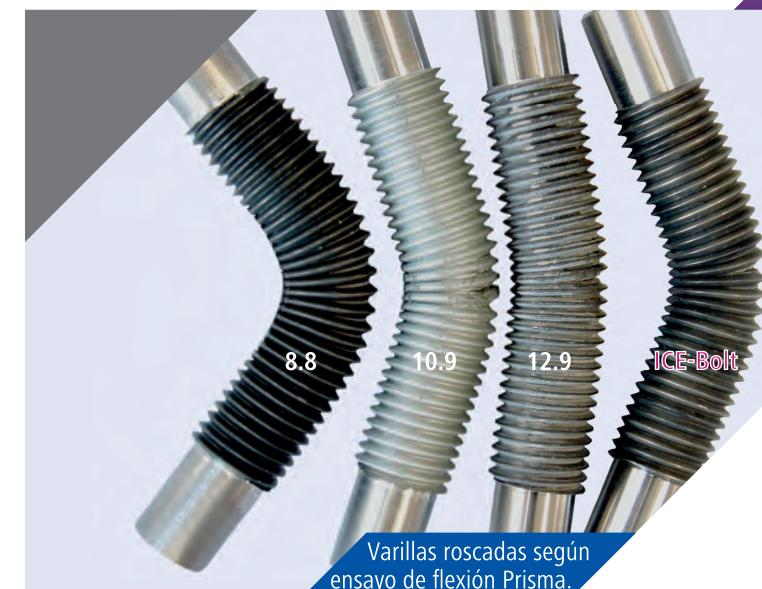
Varillas roscadas según ensayo de flexión Prisma.
