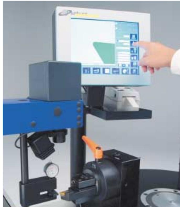
La figura muestra el modelo "saturn set" con manejo mediante pantalla tactosensible, soporte para la impresora de etiquetas, así como dispositivo de medición de la altura respecto del eje de corte, con reloj de medición.
