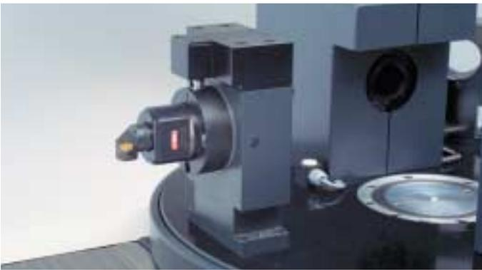
Sistema de amarre básico GA-PP de ZOLLER para la tensión accionada por potencia de adaptadores para diferentes sistemas de amarre de herramientas y para la tensión accionada por potencia de los portaherramientas para herramientas conforme a la norma DIN 69880 de espiga cilíndrica de tornillo VDI. Sistema de amarre montado sobre la mesa revólver.
