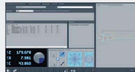
Función de software para salida de datos en formato para controlador de los datos de herramientas medidos a un lápiz USB, a una interfaz serial (en línea) y a la red o directamente a la máquina CNC.
