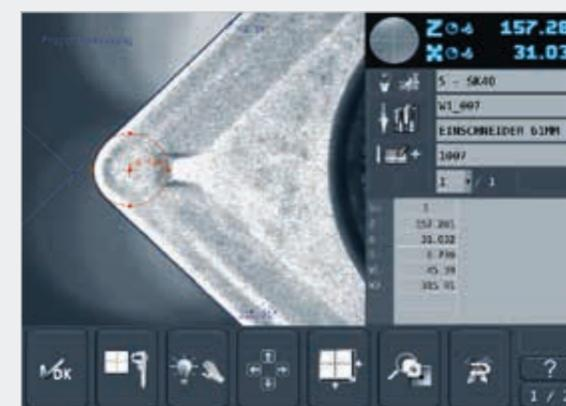
Con la inspección de filos pueden detectarse desprendimientos y signos de desgaste en imagen real en herramientas de corte hacia la derecha.
