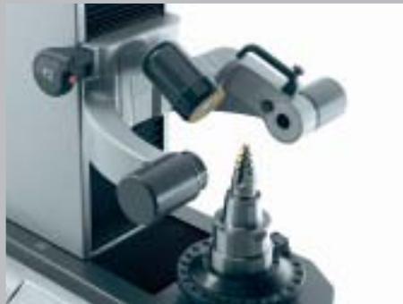
En cualquier posición, para medir en perpendicular a biseles y radios angulares.
