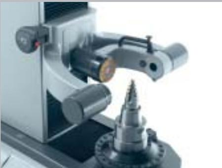
En posición radial, para medir el perímetro con luz incidente.
