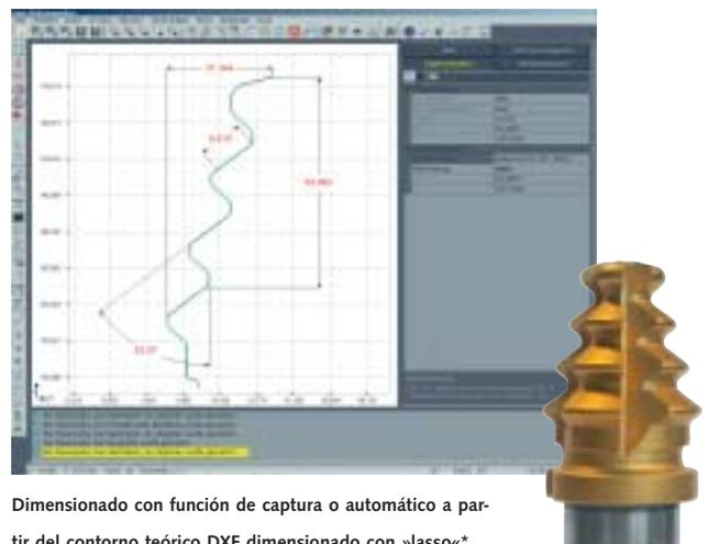
Dimensionado con función de captura o automático a partir del contorno teórico DXF dimensionado con »lasso«\*
