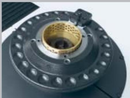
Husillo de alta precisión »A.C.E.« con precisión de concentricidad garantizada. de 0,002 mm. Sujeción universal y accionado por fuerza mecánica para herramientas de ISO/ANSI/CAT/MAS-BT/HSK/Capto/KM.
