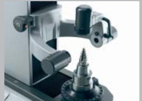
En posición axial, para medir la parte frontal en herramientas de taladrar y herramientas de fresado.
