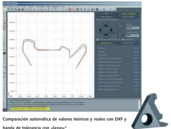
Comparación automática de valores teóricos y reales con DXF y banda de tolerancia con »lasso«\*
