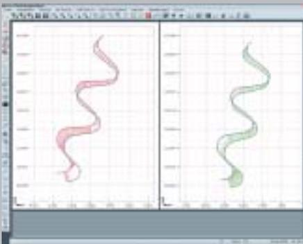
Con »CoCon« se escanea el contorno exterior de herramientas moldeadoras (izquierda) y se reflejan automáticamente las desviaciones (derecha). Los datos se pueden utilizar luego en el control de máquina o en el sistema de programación para corregir la trayectoria de erosión o afilado.
