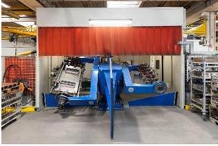
**Leyenda:** El servo posicionador de cinco ejes Yaskawa R2C con dos estaciones para carga y soldadura paralelas.
