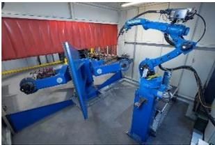
**Leyenda:** El posicionador de dos estaciones y cinco ejes de Yaskawa permite cargar por un lado y soldar por el otro.
