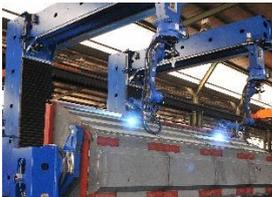
*Los dos robots Yaskawa Motoman MH2010 tienen una enorme área de trabajo. Los recorridos de los ejes Z e Y son de hasta 3 m y 3,5 m*
