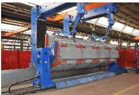
*Los dos robots Yaskawa Motoman MH2010 han sido equipados con cámaras para supervisar y seguir la soldadura en tiempo real. El sistema lleva incorporada una solución de programación y simulación offline Delfoi Apexiz. Esta solución de software, que incorpora los sensores y el sistema de visión, transmite los datos a través de Wi-Fi, lo que permite que la programación y la simulación offline se realicen de forma remota.*
