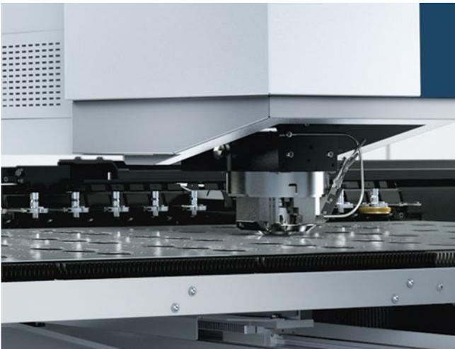
El cabezal punzonador gira cualquier útil en cualquier posición.
