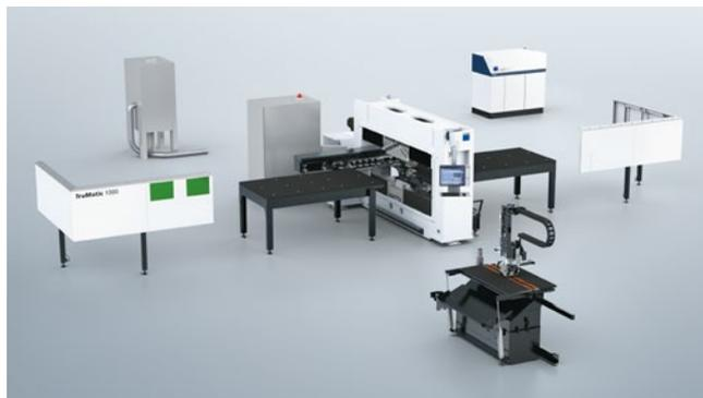
Mediante el reequipamiento del láser y otros componentes, la TruPunch 1000 se convierte en la TruMatic 1000 fiber.
