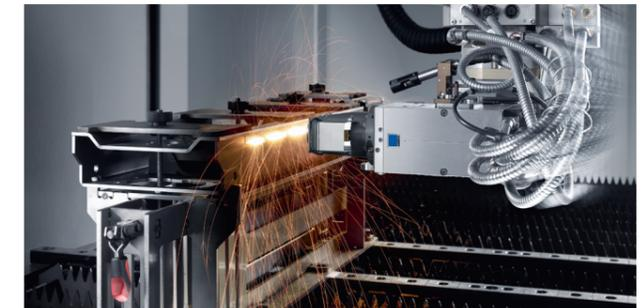
La posición de enfoque ajustable manualmente te permite realizar tanto la soldadura por penetración profunda como la soldadura por conducción térmica con la misma óptica de procesamiento.
