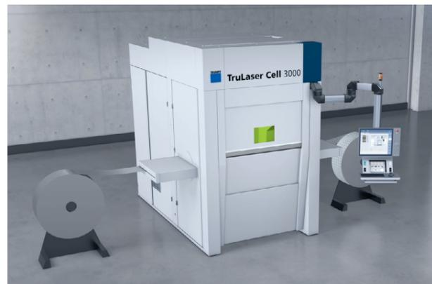
La TruLaser Cell 3000 se puede automatizar con mucha facilidad, por ejemplo, desde delante con robots, lateralmente con una conexión de bobina o en una línea de flujo.
