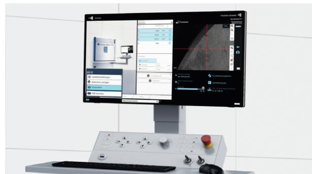
El panel de manejo ergonómico con una gran pantalla táctil se puede ajustar en altura e inclinación. Se puede colocar a la izquierda o a la derecha de la máquina.
