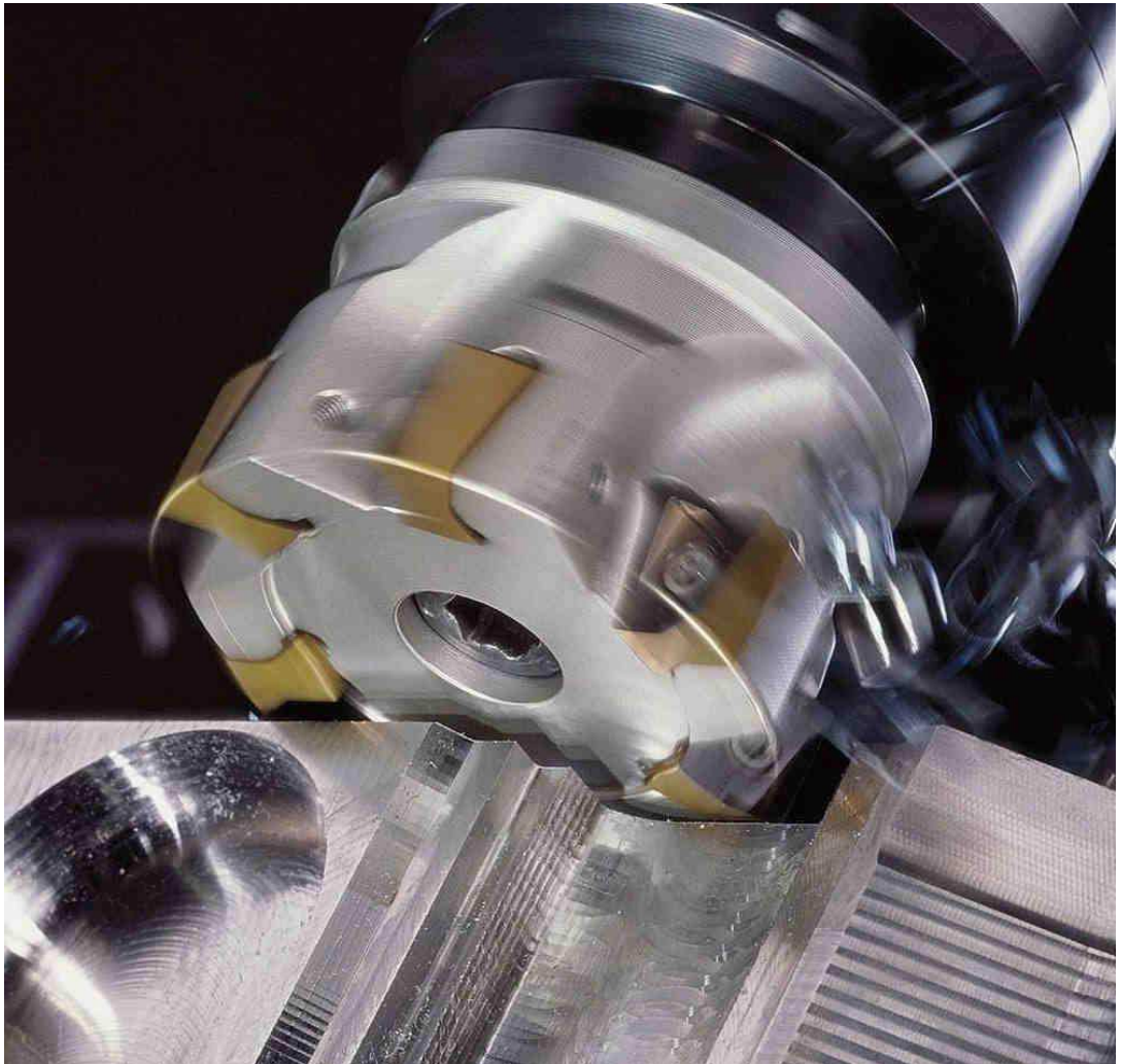
Mecanizado de nuestra aleación de aluminio TVH® TV6082.
