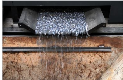
Dross removal Detalle extracción de escoria
