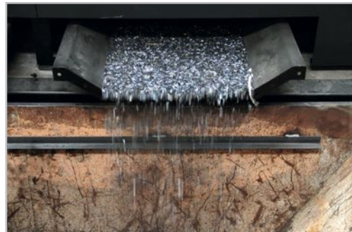
Chip evacuation Detalle evacuación escoria
