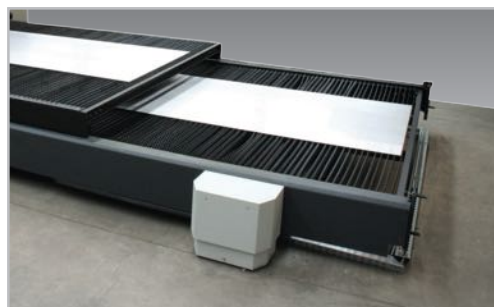
CAP®, automatic pallet changing CAP®, cambio de palé automático.
