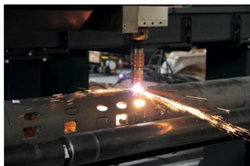
Tube plasma cutting Detalle corte de tubo con plasma
