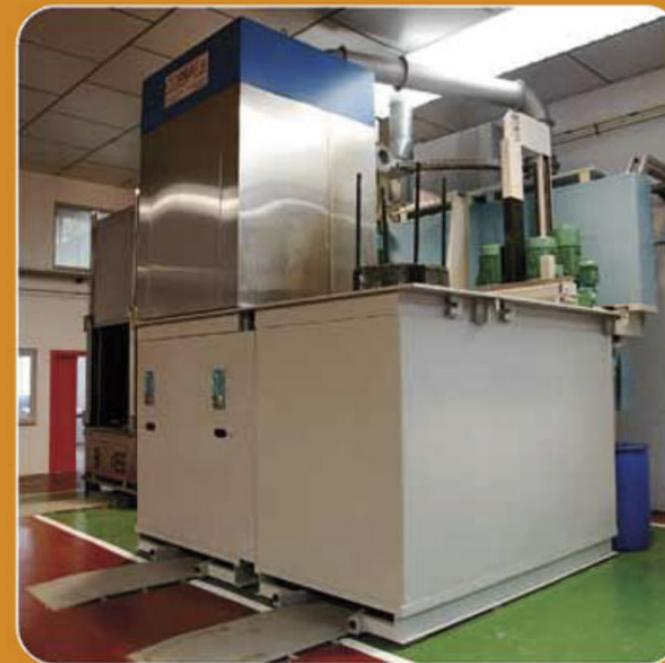
COLUMNA HORNO DE AUSTENIZACIÓN, CEMENTACIÓN Y CARBONITRURACIÓN IPSEN TQ4-5:
