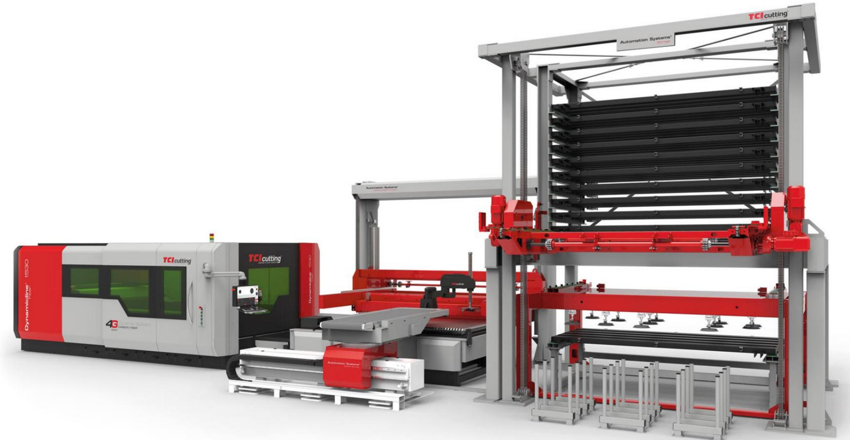
Dynamicline Fiber con carga / descarga simultánea, almacenamiento y clasificación inteligente.
