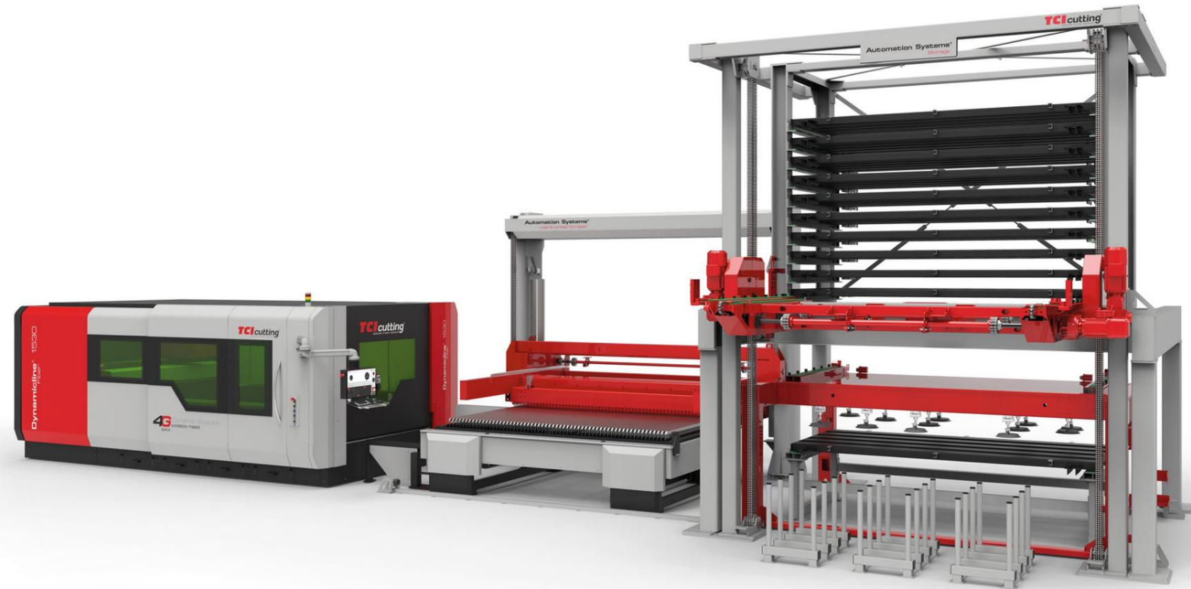
Dynamicline Fiber con carga / descarga simultánea y almacenamiento inteligente.
