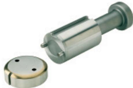
Para alinear las estaciones A y B, se requieren una o dos herramientas para cada tamaño de estación, dependiendo del tipo de máquina. Para una torreta de una hilera, se requiere una herramienta para alinear cada estación. Para una máquina de hileras múltiples, se requieren dos herramientas para alinear cada estación (una en la parte delantera de la estación y otra en la trasera).
