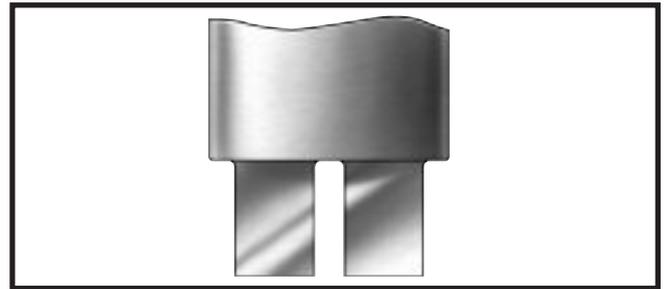
**ESTILO "C"**: el patrón de la herramienta de punzones múltiples se maquina con precisión y se rectifica a partir de un punzón macizo. Este diseño tiende a ser menos costoso para trabajos de corto plazo. Sin embargo, si este punzón sufre un daño debe pedirse un punzón completamente nuevo, en lugar de un inserto económico como ocurre con el estilo 'B'.
