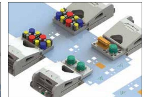
Una segunda estación de punzonado CNC para herramientas grandes (LT) ofrece una extensión más eficiente, pero aun así flexible, de punzonado de patrones fijos, saneamientos (trimming), punzonado a lo ancho, embutición y muestado.
