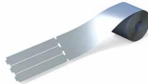
Las chapas se cortan longitudinalmente bien usando cortes parciales (uno a uno) o con un golpe completo de la cizalla. En el apilador Pick & Place, las chapas se apilan de una en una o varias a la vez.
