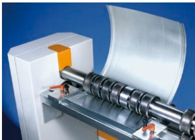
Bagues ajustables à la largeur de pièce Rodillos ajustables al ancho de pieza
