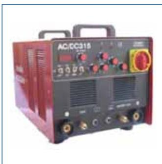
Equipo trifásico de soldadura TIG AC/DC con tecnología inverter para todo tipo de materiales, encendido del arco por alta frecuencia. Dotado de amperímetro digital, control manual de rampas de subida y bajada, pre y post-gas, arco pulsado con dos niveles de corriente y función de limpieza para la soldadura de aluminio. Soldadura de todo tipo de electrodos revestidos.
