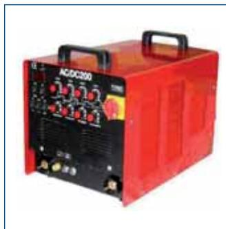
Equipo monofásico de soldadura TIG AC/DC con tecnología inverter para todo tipo de materiales, encendido del arco por alta frecuencia. Dotado de amperímetro digital, control manual de las rampas de subida y bajada, pre y post-gas, arco pulsado con dos niveles de corriente y función de limpieza para la soldadura del aluminio. Soldadura de todo tipo de electrodos revestidos.
