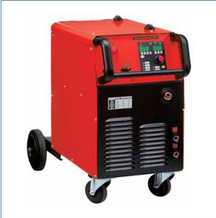
Equipo de soldadura MIG-MAG compacto, bobinado en cobre, garantizando una elevada calidad en todas las condiciones de trabajo. Programas sinergicos preconfigurados para facilitar la elección de los parámetros de soldadura en todo tipo de materiales. Voltímetro-amperímetro digital y sistema de arrastre de hilo de 4 rodillos.
