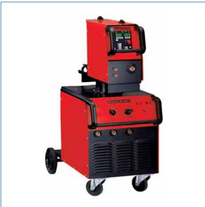
Equipo de soldadura MIG-MAG con dispositivo de arrastre de hilo separado. Transformador bobinado en cobre adaptado a la soldadura, todo tipo de materiales. Cuenta con programas sinergicos preconfigurados para facilitar la elección de los parámetros óptimos de soldadura. Voltímetro-amperímetro digital. Motor de arrastre de 4 rodillos y prolongación entre carro y máquina de 10 mts.
