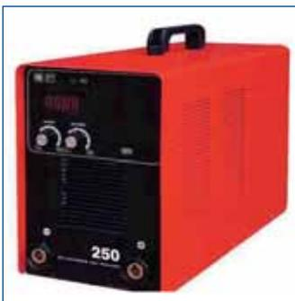
Equipo trifásico de soldadura para todo tipo de electrodos revestidos, con tecnología inverter. Dotado de amperímetro digital y regulación manual del Hot Start. Soldadura TIG, en corriente continua, con encendido del arco por contacto. Antistick predeterminado de fábrica.
