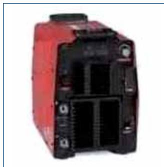
Equipo multifunción con tecnología inverter, ideales para la soldadura de hilos tubulares sin gas en estructuras. Dotados con tecnología AUTOLINE que permite conectar el equipo entre 230 y 460 V en una línea trifásica y a 50/60 Hz. Salida de 10 A para poder conectar refrigeradores de agua.
