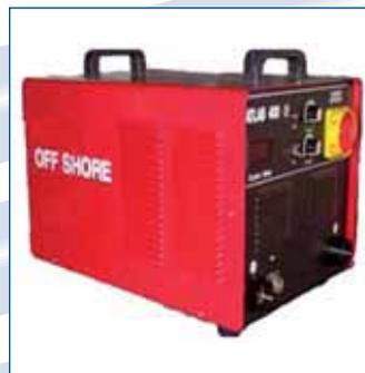
Equipo trifásico de soldadura para todo tipo de electrodos revestidos, con tecnología inverter. Dotado de amperímetro digital y regulación manual del Hot Start y del Arc Force. Soldadura TIG, en corriente continua, con encendido del arco por contacto. Antistick predeterminado de fábrica.
