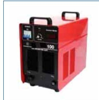
Equipo trifásico de corte por plasma, para todo tipo de materiales (acero, carbono, aluminio, inox, etc...), con tecnología inverter. Dotados de antorcha manual de 6 metros y regulación electrónica. Bajo peso y gran portabilidad. Ideal para trabajos industriales, reparación y mantenimiento.
