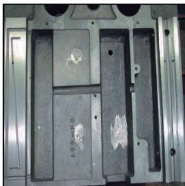
Sistema interno de lubricación en la base.
