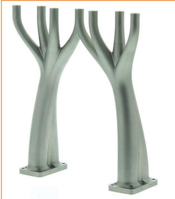
La fabricación aditiva metálica es un proceso de creación de un objeto 3D a partir de un modelo CAD añadiendo finas capas de metal una a una.
