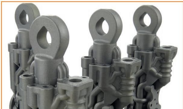
La tecnología de fabricación aditiva metálica permite producir geometrías de gran complejidad, ya que no tiene las limitaciones asociadas al mecanizado sustractivo y otras técnicas de fabricación tradicional.
