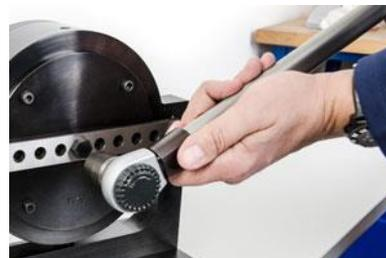
Determinación del coeficiente de fricción
