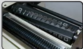
Eje de cepillado en espiral integrado
