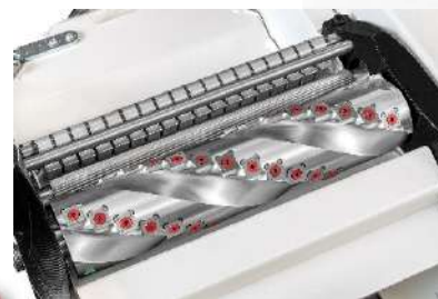
Cabezal helicoidal 3 filas de 17 plaquitas
