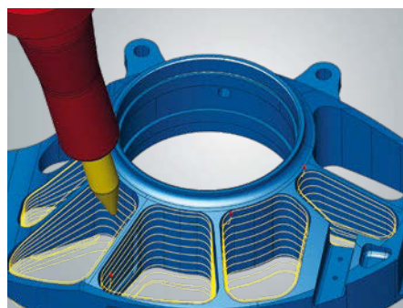
El uso de fresas de barril también permite ahorrar mucho tiempo en el torneado-fresado
