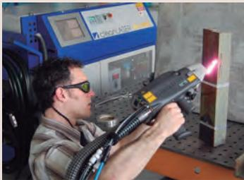
**Equipos láser portátiles** para limpieza y tratamiento de superficies. Los equipos permiten realizar de forma delicada trabajos de decapado de precisión o limpieza en una amplia variedad de aplicaciones industriales, con un elevado rendimiento.
