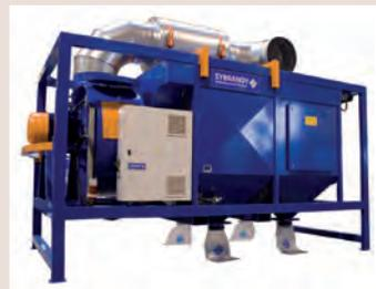
**Colectores de polvo móviles**, para la captación del polvo generado durante el chorreado. Robustos y de fácil transporte y manejo. Amplia gama de capacidades disponible, hasta 20.000 m3/min.
