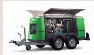
Amplia gama de **equipos de Alta Presión y Waterjetting** (hasta 3000 bar), en versiones eléctricas o autónomas (skid, remolque...). Disponibles en diferentes configuraciones para adaptarse a todo tipo de aplicaciones.
