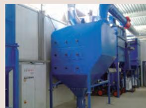
**Colectores de polvo ATEX** especiales para cabinas de metalizado, seguros y fiables, adaptados a cada instalación.
