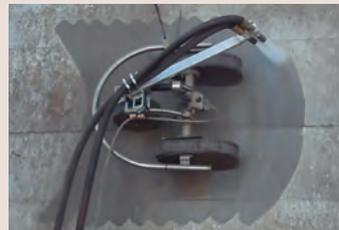
**Robots para chorreado de superficies metálicas.** Operados por control remoto, se adhieren a la superficies mediante potentes imanes permanentes. Permiten realizar el chorreado en seco o húmedo.
