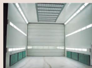
**Cabinas de pintura líquida y de pintura polvo.** Aplicación manual y automática. Muros de aspiración. Calefactores, hornos de secado. Diseños adaptados a las necesidades y tipología de aplicación.
