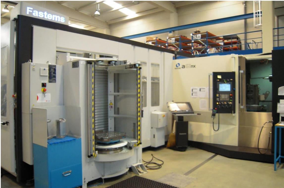
Centro de mecanizado horizontal MAKINO equipado con 313 htas. y FASTEMS de 12 palets.
