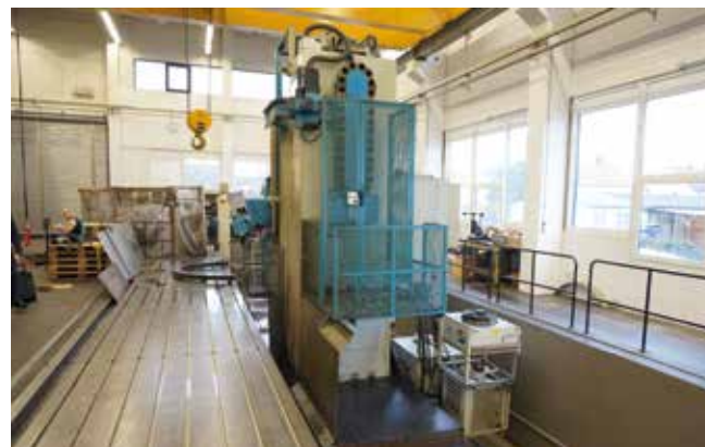
ZAYER 30 KCU-22.000 (2000) SIEMENS 840D. Cabezal Automatico 0.001°/0.001°. 4 uds. Mesas Stoller 6000 x 2000 x 300 mm. Refrigeracion Armario Electrico. Recorridos (x,y,z) 22000 / 1500 / 3000 mm. Refrigeración Interna 20 Bar. ATC 30 POS. Evacuador Viruta.
