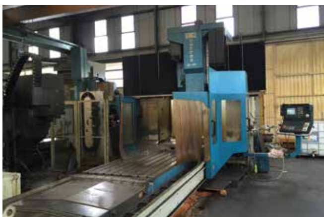
NICOLÁS CORREA FP 40/40 S ATC UDG (2001) SIEMENS 840 D. Superficie Mesa 4000 x1250 mm. ATC 30 POS. Recorridos (x,y,z) 4000 /2500 /1000 mm. Paso entre columnas 2000 mm. Doble evacuador viruta. Refrigeración interna.
