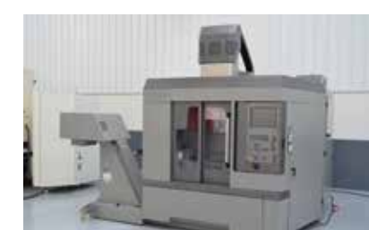
IBARMIA ZV-25/U600 5 EJES (2002/2017) HEIDENHAIN iTNC - 530. Mesa Ø 400 mm. Recorridos (x/y/z): 600 / 428 / 410 mm. Curso Eje A +120°/-120° 0.001°. Curso Eje C: continuo. Ref. Int. Evacuador de Viruta.
