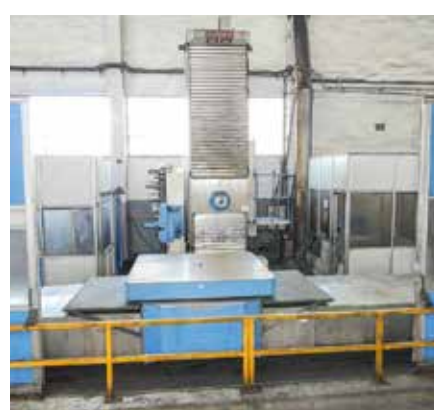
JUARISTI TS-3 5 EJES (2004) FAGOR 8070. Diametro Caña 130 mm. Recorridos (x/y/z/w) 6000 / 3500 / 1975 / 800 mm. Evacuador Viruta. Ref. Externa. Mesa Rotatoria MG20 2000 x 2000 mm. ATC 60 POS.
