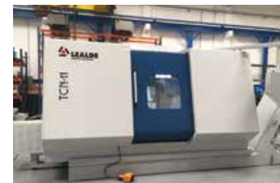
LEALDE TNC 11 (2004) FANUC 21i. Recorridos (x/z):1500/1200 mm. Distancia entre puntos: 1500 mm. Plato Ø315 mm. Eje C+ Herramientas Motorizadas. Luneta Autoblock. Evacuador Viruta.
