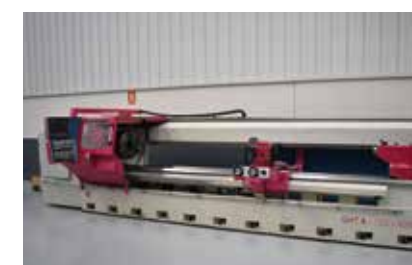
GEMINIS GHT-4 720X4000 (2002) SIEMENS 810. Dist. entre puntos: 4000 mm. Ø Máx. sobre Bancada/carro: 720/470 mm. Ø Caña Contrapunto: 100 mm. Plato Universal 3 Garras. Luneta Fija 50 / 220.
