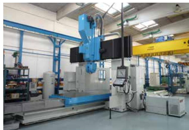
ZAYER KP-5000 5 EJES CONTINUOS (1997/2017) HEIDENHAIN TNC 530 HCSI 19" NUEVO. Cabezal Automático Continuo 360.000 Pos. Superficie mesa 5000 x 1800 mm. Recorridos (x,y,z) 4710 / 3050 / 1100 mm. Paso entre columnas 2,300 mm.
