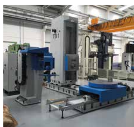
JUARISTI TX15 (2007) HEIDENHAIN i530. Mesa Rotatoria Ø1300 mm. Recorridos (x/y/z/w) 2000/2000/1500/600 mm. Evacuador Viruta. Ref.Interna y externa. ATC 30 POS. Carenado Integral.
