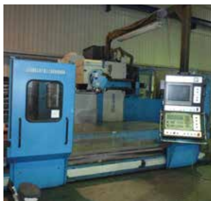
ZAYER 20 KFU-3000 (2005) HEIDENHAIN TNC 530i. Cabezal Automático 2.5°/1°. Sup. Mesa:3000x1000 mm. Recorridos (x,y,z): 2700 /1200 /1000 mm. ATC 30 POS. Evacuador de viruta.
