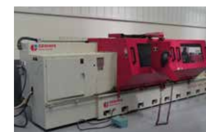
GEMINIS GHT-4 620X3000 (2007) FANUC 21i TB. Dist. entre puntos: 3000 mm. Ø Máx Volteo sobre Bancada/carro: 620/370 mm. Torreta Automática 4 Pos. Ref Int. Evacuador. Ø caña:104mm. Incluye Herramientas.
