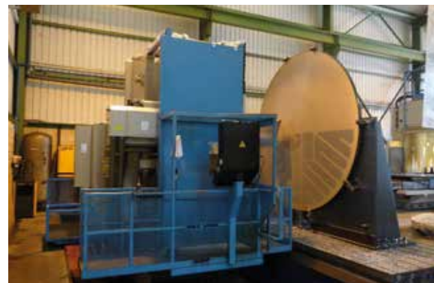
ZAYER 30 KC-5000 (2003) HEIDENHAIN TNC 430 Cabezal Automático 45° 0,001°/0,001°. Cabezal Salida Directa. Recorridos (x,y,z) 5000 x1250 x 2000 mm. Extractor de Viruta. Superficie Mesa 5000 x 2000 mm. Refrigeración Interna y Externa.
