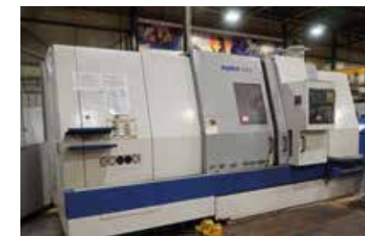
DOOSAN PUMA 500 (2004) Fanuc 18i T. Distancia entre puntos: 1650 mm. Recorridos (X/Z):4707/1650 mm. Plato Ø630 mm. Evacuador de viruta. Torre 12 Pos. Medidor Automático de herramienta.
