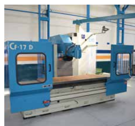
NICOLÁS CORREA CF 17-D (2001) HEIDENHAIN TNC-426. Superficie Mesa: 2000 x 700 mm. Recorridos (x,y,z): 2000 / 800 / 800 mm. Volante Portátil.
