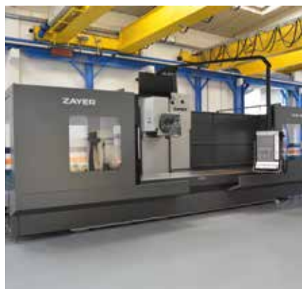
ZAYER 30 KF 3000 AR (2001) HEIDENHAIN TNC 430. Cabezal Automático 0.001°/0.001°. Superficie Mesa 3000 x 1000 mm. Recorridos (x,y,z) 2708 / 1250 / 1513 mm.
