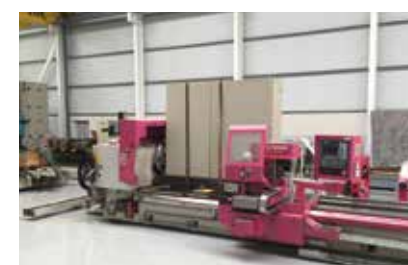
GEMINIS GHT7 4G (2003) FAGOR 8055 TC. Dist. entre puntos 5000 mm. Ø Caña: 180 mm. Eje C + Hts. Motorizadas. Plato Hidráulico Ø 360 mm. Torreta 12 Pos. Evacuador Viruta.
