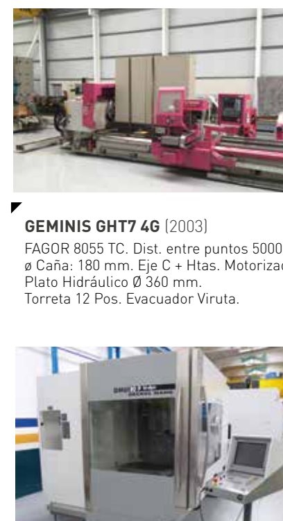
DMG DMU 80P HI-DYN 5 EJES (2000) HEIDENHAIN TNC 426. Mesa Ø 630 mm. Recorridos (x/y/z): 800 / 700 / 600 mm. Rotación Mesa Continua. ATC 30 POS. Ref. Int. 40 Bar. Evacuador Viruta.
