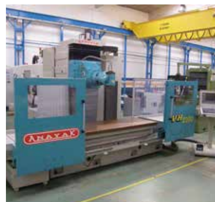
ANAYAK VH 2200 (1992) HEIDENHAIN TNC 410. Superficie Mesa: 2200 x 700 mm. Recorridos (x,y,z): 2000 / 920 / 900 mm. Amarre Hidráulico de Herramientas.
