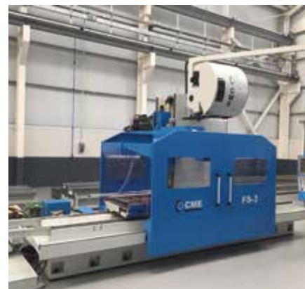
CME FS-3 (2007) HEIDENHAIN TNC-530i. Cabezal Automático 2.5°/2.5°. Superficie Mesa 2700 x1000 mm. Recorridos (x,y,z) 2500 /1200 /1500 mm. ATC 24 POS. Evacuador Viruta. Ref. Int.
