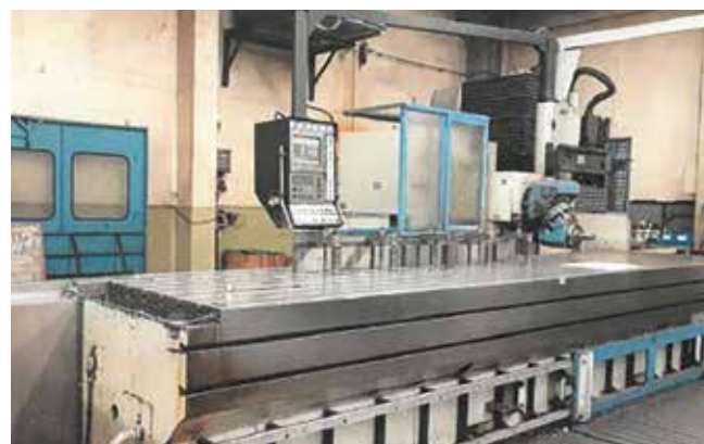
ZAYER 20 KMU 6000 (1997) HEIDENHAIN TNC 426 PB. Cabezal Automático 0.001°/0.001°. Superficie Mesa 5700 x 1200 mm. ATC 40 POS. Evacuador Viruta. Recorridos (x,y,z): 5700 / 1210 / 1000 mm. Refrigeracion Armario Electrico.
