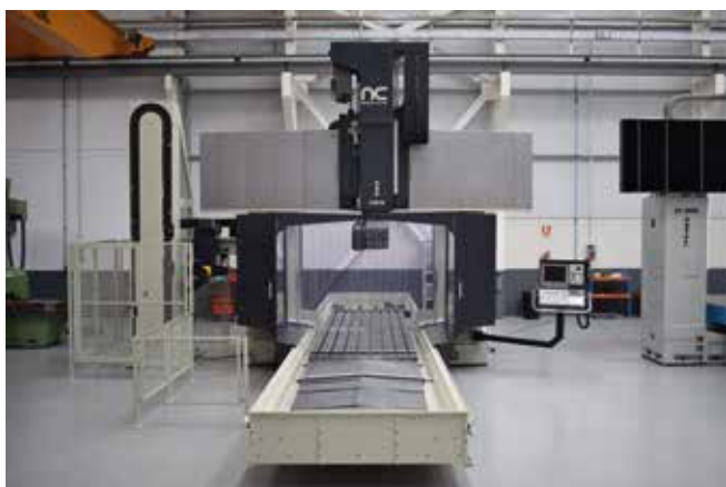
NICOLÁS CORREA FP 40/40 S ATC UDG (1997/2017) HEIDENHAIN TNC 426 PA. Cabezal Automático 2,5°/2,5°. Superficie Mesa 4500 x1250 mm. Paso entre columnas 2300 mm. Recorridos (x,y,z) 4000 / 3000 / 1000 mm. ATC 60 POS. NIKKEN CNC 320.
