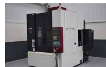
OKK VP 400 (2005) FANUC 160 is MB. Mesa: 900 x 410 mm. Recorridos (x/y/z): 600 / 410 / 460 mm. ATC 60 POS. Dim. Evacuador de Virutas. Ref. Int. 40 Bar. 4° Eje Nikken.
