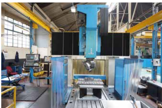
NICOLÁS CORREA FP 40/30 (1997) HEIDENHAIN TNC 426PD. Cabezal Automático Ortogonal UDG 2,5°/2,5°. Sup. Mesa 3000 x 1250 mm. Recorridos (x,y,z) 2500 / 1250 / 1100 mm. Paso entre columnas 2000 mm. ATC 10 POS. Refrigeración Interna 15 Bar.
