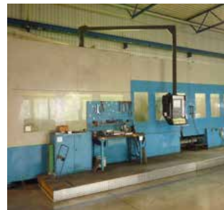
ZAYER 30 KF 5000 AR (1999) HEIDENHAIN TNC 426 PB. Cabezal Automático 0.001°/0.001°. Cabezal Twist 0.001°/0.001°. Recorridos (x,y,z) 4700 / 1500 / 2000 mm. Extractor Viruta.
