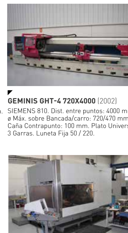
DMG DMU 125P 5 EJES (2003) HEIDENHAIN 426. Mesa: 1250 x1000 mm. Recorridos (x/y/z): 1250 / 880 / 800 mm. Rotación Mesa Continua. ATC 30 POS. Ref. Int. 40 Bar. Evacuador Virutas.
