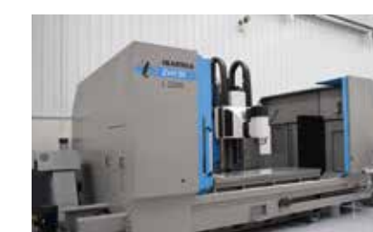
IBARMIA ZVH-2200 (2003) HEIDENHAIN TNC 530. Superficie Mesa: 2600 x 850 mm. ATC 40 POS. Recorridos (x/y/z): 2200 / 800 / 860 mm. Evacuador Virutas. Giro Automático Cabezal ± 1050.
