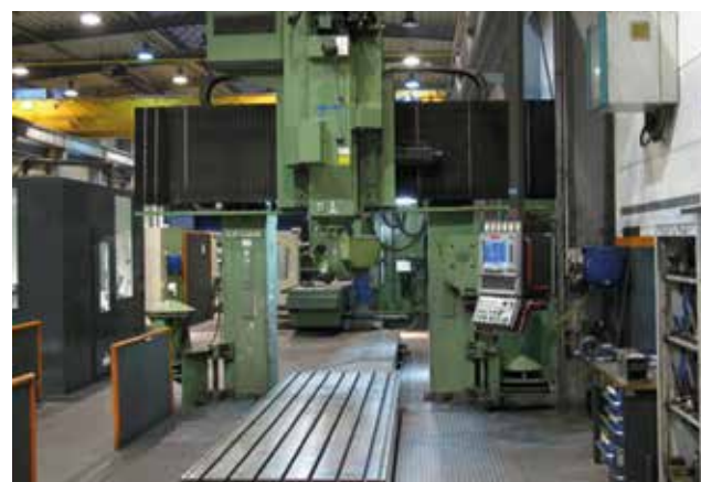
ZAYER KP-5000 (1996) FIDIA M20. 3 Cabezales Automático 1°/1° salida directa y alargador. Cambio Cabezales. Paso entre columnas 1800 mm. Recorridos (x,y,z) 4710 / 2560 / 1100 mm. Refrigeración interna.
