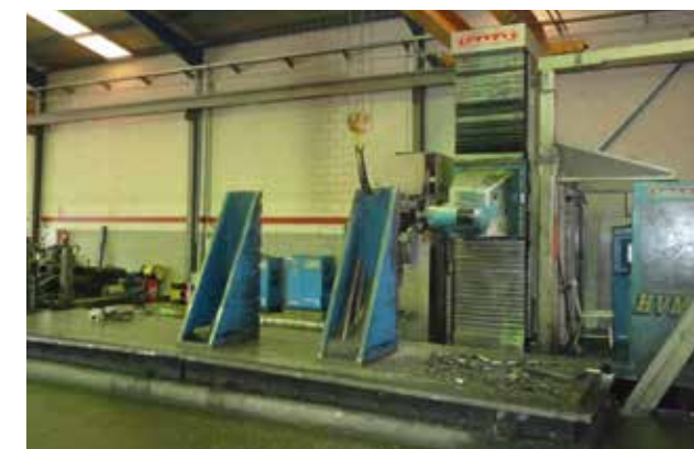
ANAYAK HVM-8000 (2002) SIEMENS 840. Cabezal Automático 2.5° - 2.5°. Superficie Mesa 8000 mm x 2000 mm. ATC 40 POS. Refrigeración interna. Evacuador de Viruta. Recorridos (x,y,z) 7300 / 1500 / 2500 mm.
