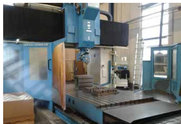
ZAYER KPCU-4000 AR (2004) HEIDENHAIN TNC 530. Cabezal Automático 45° 360.000 pos. Cabezal Twist 360,0000 pos. Cambio cabezales 2300 mm. Paso entre Columnas 2800 mm. ATC 80 POS. Recorridos (x,y,z) 4000 /3550 /1100 mm. Refrigeración Interna. Doble evacuador virutas.
