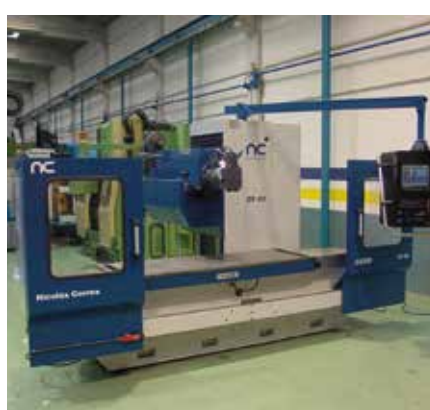
NICOLÁS CORREA CF 20/20 (2005) HEIDENHAIN TNC-407D. Recorridos (x,y,z) 1800 / 800 / 800 mm. Amarre Hidráulico de Herramientas. Superficie Mesa 2000 x 700 mm.
