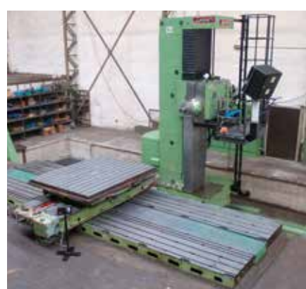
JUARISTI MDR 150 CM (1999/2017) FAGOR 8050M. Cabezal Alargador. Recorridos (x,y,z) 8000 / 3000 / 500 / 1000 mm. Diametro Caña: 150 mm. Superficie Mesa Stoller: 8000 x 2600 mm. Evacuador de Viruta.
