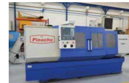
PINACHO TAURUS 260X2000 (2006) Fagor 8050 TC. Max. Sobre Bancada: 530 mm. Distancia entre puntos: 2000 mm. Max Sobre Carro Lolg. 475 mm. Evacuador Viruta. Anchura Bancada 350 mm. Torre Automático 8 POS.
