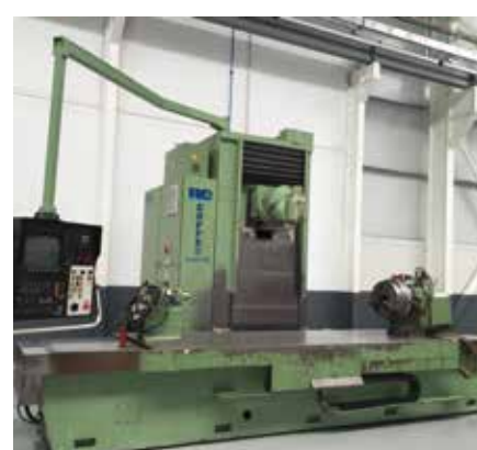
NICOLÁS CORREA A25/30 (1992) HEIDENHAIN TNC 415. Superficie Mesa: 3500 x 1000 mm. Recorridos (x,y,z): 3000/1200/1000 mm. Divisor 4° Eje Ø 400 mm. Cabezal Automático 2.5°/2.5°.
