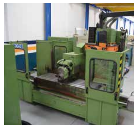
ZAYER ZFU- 2000 (1992) CNC FAGOR 8050M. Cabezal Automático 0-180°. Superficie Mesa 2000 x 630 mm. Recorridos (x,y,z) 1800 x 800 x 800 mm. Evacuador de Viruta. ATC 30 POS.
