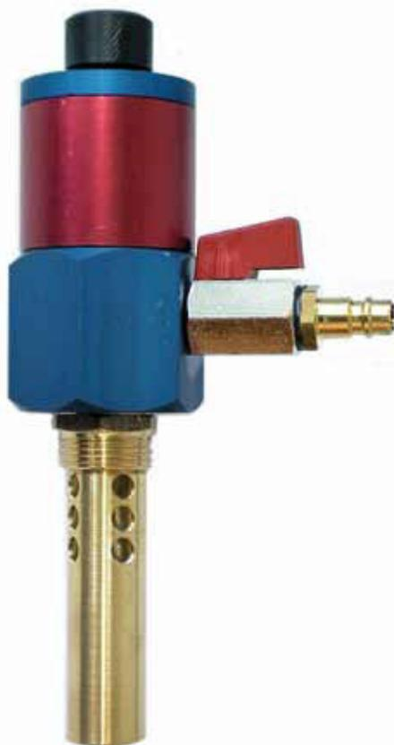
La bomba Power-Vac de ARIANA es una bomba de doble función, de aspiración y de compresión, que se acciona con aire comprimido. Se utiliza ante todo para llenar o vaciar recipientes de lubricantes y refrigerantes. El concepto de esta bomba permite su montaje rápido y sin problemas en barriles estándar. Se enrosca en el ojo de barril y se conecta al aire comprimido. En la otra abertura del barril se fija un tubo de extracción.
