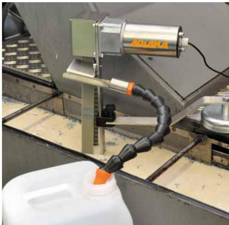
La cinta colectora de aceite se sujeta sobre el recipiente para líquidos por medio de un disco magnético, preferiblemente sobre la entrada del líquido en la parte opuesta. La placa base de la unidad motriz tiene que ser colocada a unos 300 mm sobre el nivel máximo del líquido. En los soportes de salida se coloca la manguera que lleva a un tanque.
