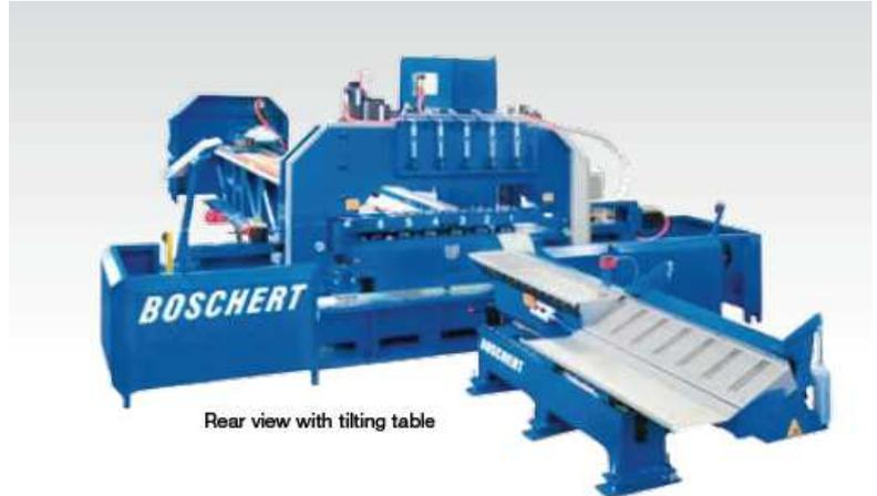
En las estaciones de cinco herramientas se puede incluir una estación de corte de 80 x 8 mm o 50 x 10 mm. Dos de las estaciones pueden ser equipadas con un multi-tool para llegar a un total de hasta 15 herramientas.
