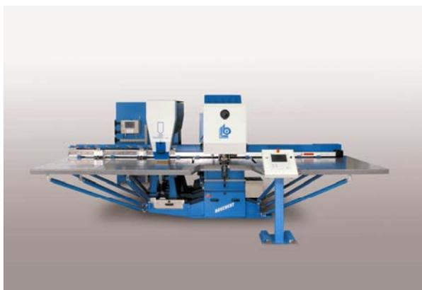
Otra de **corte por plasma** con la rigidez suficiente para garantizar la ausencia de vibraciones provocadas por el punzonado, dejando el máximo espacio posible entre los dos cabezales garantizando así una alta precisión y evitando cualquier desviación entre los mismos. **Gracias al cabezal del plasma es posible realizar distintas piezas con contornos ondulados.**
