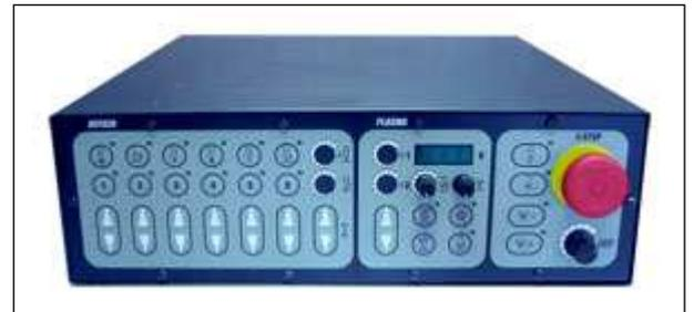
Para el corte por plasma, la unidad viene equipada con una función que reduce el tiempo de acercamiento de la antorcha a la altura de la ignición mediante acortamiento del levantamiento de la antorcha entre dos cortes, así se incrementa la eficiencia en el corte cuando se realizan piezas con muchos piercings.
