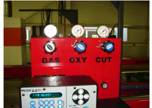
Cada válvula relativa es activada por una válvula solenoide. Baja presión de gas calentado y oxígeno es usado durante el corte. Alta presión del gas calentado y oxígeno es usado para precalentamiento del material antes de empezar a cortar con oxígeno. Válvulas relativas de corte por oxígeno proporcionan la presión progresiva (4 etapas) incrementándose durante la perforación del material. Es recomendado hasta espesores de 100 mm. Es anexo al control con la ayuda de contactores tipo relés.
