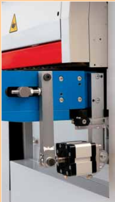
Centrado automático cinta Centragem automática da cinta
