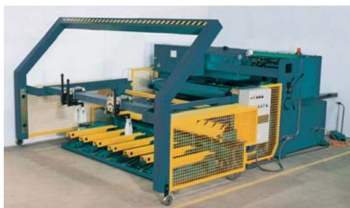
Todo ello es controlado por el CNC CYBELEC el cual permite trabajar de forma manual, semi-automática o automática permitiendo al operario que solamente tenga que ir alimentando las chapas a la cizalla.
