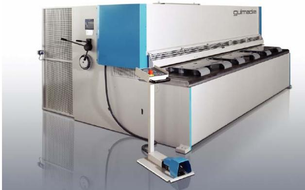
escamoteamiento parcial del tope trasero durante el corte y total al final del curso. Y un conjunto de brazos de escuadra y de apoyo de chapas, integran cuchillas para acero y acero inoxidable y dispositivo de iluminación de la línea de corte.
