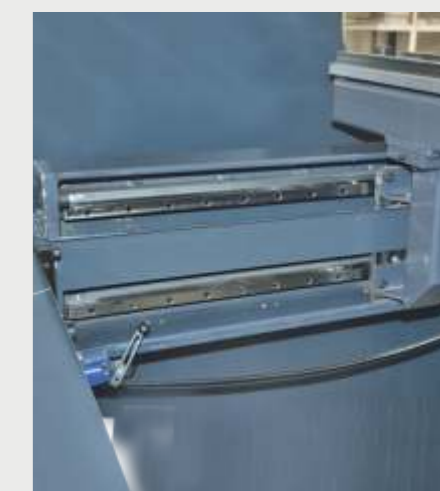
Movimiento Lineal Guiado y más Fuerte del Tope Trasero X
