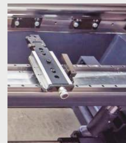
Doble Sistema de Guía Lineal para Estabilizar la Viga
