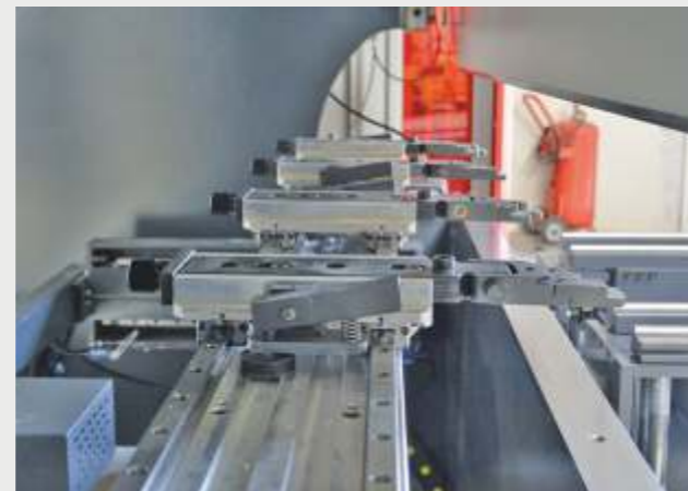
Dedos Adicionales del Tope Trasero 2-3-4-5-6 Ejes del Tope Trasero
