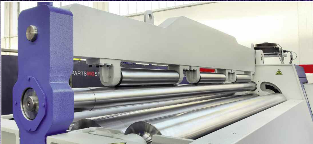
• Sistema antiflessione • Anti - deflection system • Système anti-flexion • Sistema anti-flexión
