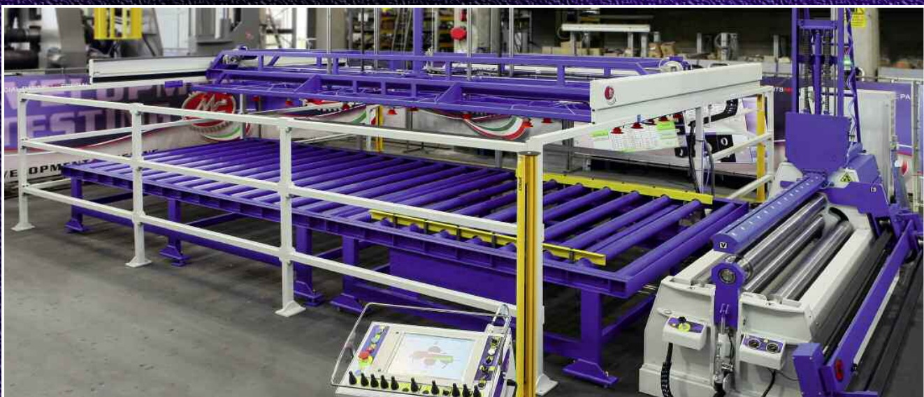
• Impianto automatico con rulliera e caricatore a ventose • Automatic system with roller conveyor and suction cup loader • Système automatique avec convoyeur à rouleaux et chargeur à ventouse • Sistema automático con transportador de rodillos y cargador de ventosas
