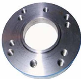
El anillo adaptador para la caja de cambios se monta primero en la brida de salida de la caja de cambios. El par aplicado depende de la dimensión de los tornillos:
