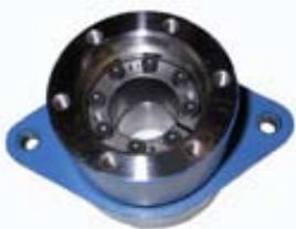
El soporte está fijado con tornillos al casco, pero amortiguada por bloques de goma. El cojinete absorbe las fuerzas de propulsión adelante y reversa.
