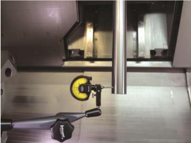
***Para verificación y puesta en geometría de máquinas de 3 y 5 ejes.***
