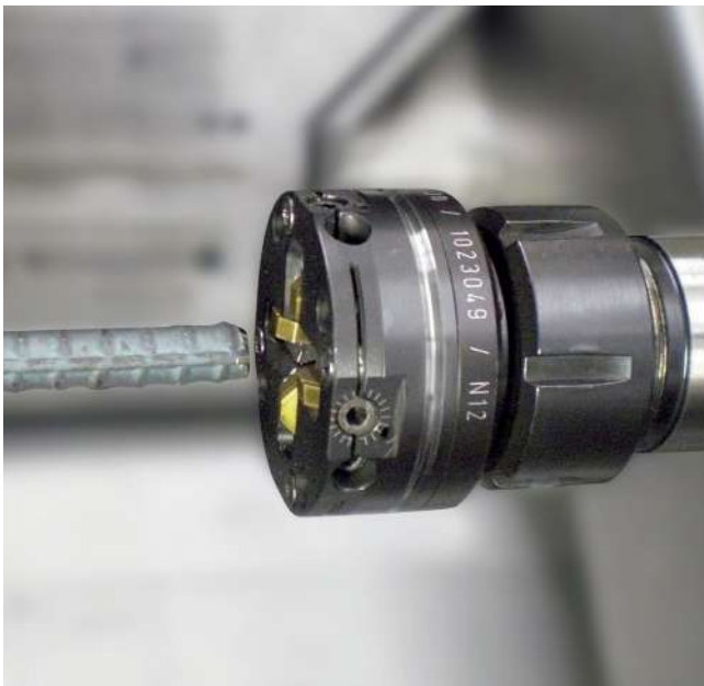
Torneado barra corrugada con pelador FS Barpeeling of rebar with FS Turning head
