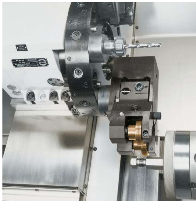
Cabezal tangencial T27F con portacabezal ajustable montado en un torno automático CNC Tangential rolling attachment T27F with adjustable tool holder mounted on a CNC-lathe
