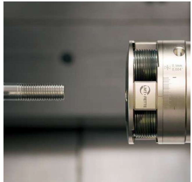
Rosado por laminación de roscas muy largas con un cabezal axial EVOline Rolling threads with greater length with axial rolling head EVOline
