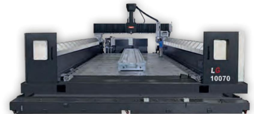
Cambio automático de cabezales.
