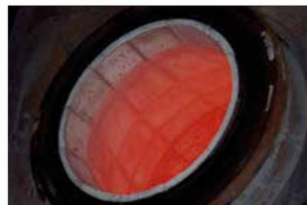
\ Pieza prefabricada en horno rotativo
