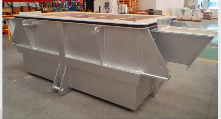
Desgasing vent \ Caja desgasificado
