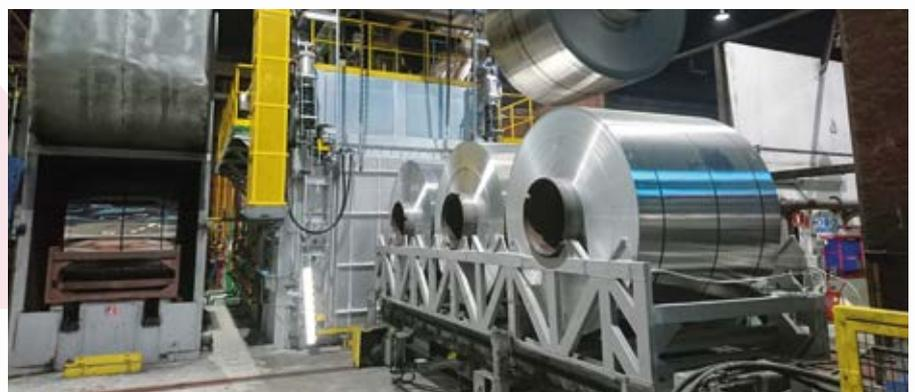
\ Horno recocido bobinas
