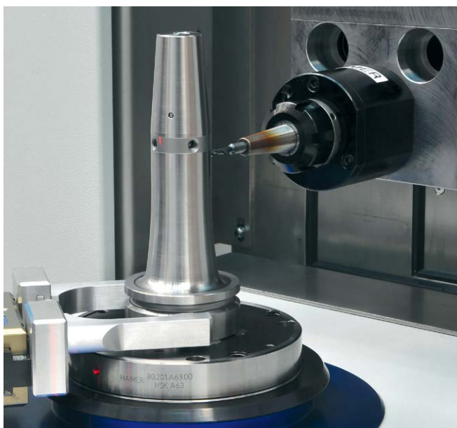
Eliminación automática del desequilibrio a través de la unidad de mecanizado CNC Compensação automatizada de desbalanceamento através da unidade de usinagem CNC
