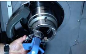
Coloque la pinza en el mandril utilizando la herramienta manual de cambio. El botón libera el gatillo para su instalación
