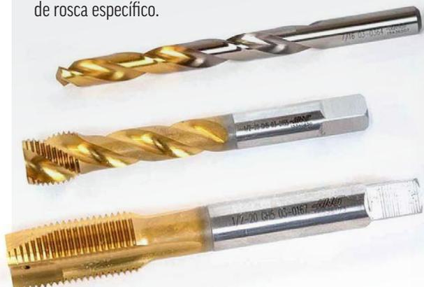
Se usan machos de roscar para cortar roscas de tornillos en orificios pretaladrados o perforados. Los filos de corte del macho de roscar retiran material de la pieza de trabajo, empujando las virutas frente al macho o sacándolas del estriado, según el tipo de macho.
