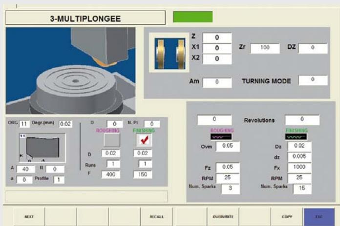
Il cliente può scegliere tra i controlli numerici Fagor o Fanuc d'ultima generazione. In qualunque dei due casi s'integra il pacchetto completo nel quale motori regolatori e drivers appartengono alla stessa marca.
