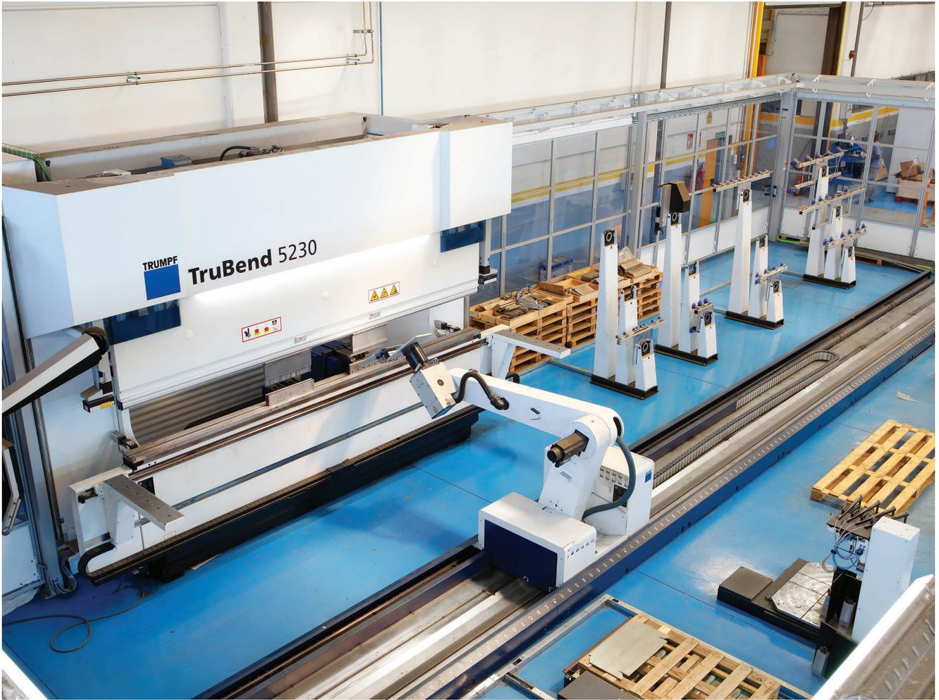
Varios centros de plegado tanto eléctricos como hidráulicos, con unas fuerzas de plegado de 360 KN, 500 KN, 850 KN, 1300 KN, 2300 KN, con unas longitudes de plegado que van desde los 500 mm hasta los 4250 mm.
