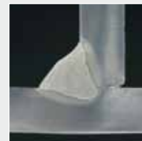
/ Soldadura en ángulo de acero de 10 mm
