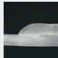
/ Soldadura solapada de acero de 3 mm
