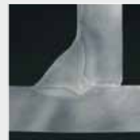
/ Soldadura en ángulo de acero de 10 mm
