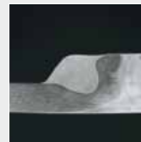
/ Soldadura solapada de acero de 3 mm
